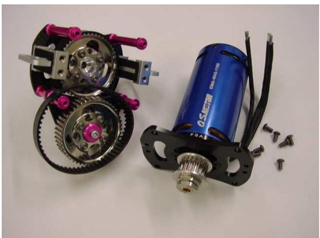
モータープレートのボルトを外し
